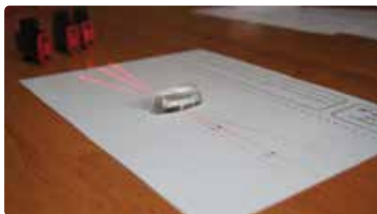
شکل ۵-۲۰ پرتوهایی که به مرکز نوری عدسی بتابند بدون انحراف از عدسی خارج می‌شوند.
