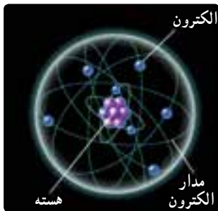
شکل ۳-۲- در اتم خنثی تعداد پروتون‌های هسته با تعداد الکترون‌ها برابر است.
