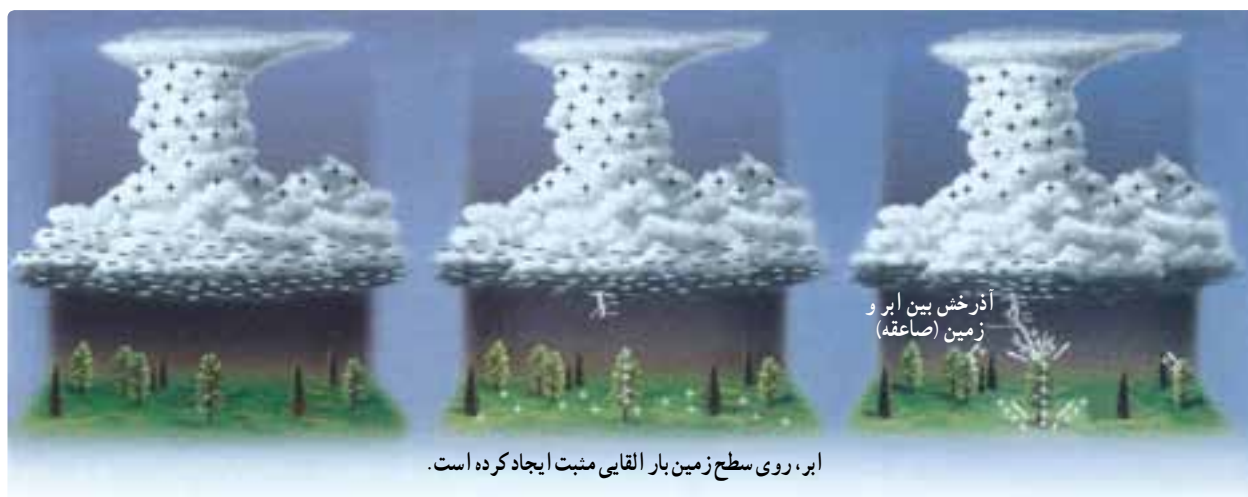
شکل ۳-۶- وقتی ابری که بار الکتریکی دارد نزدیک سطح زمین قرار بگیرد در سطح زمین بار القایی ایجاد می‌کند و بین ابر و زمین تخلیه الکتریکی رخ می‌دهد.
