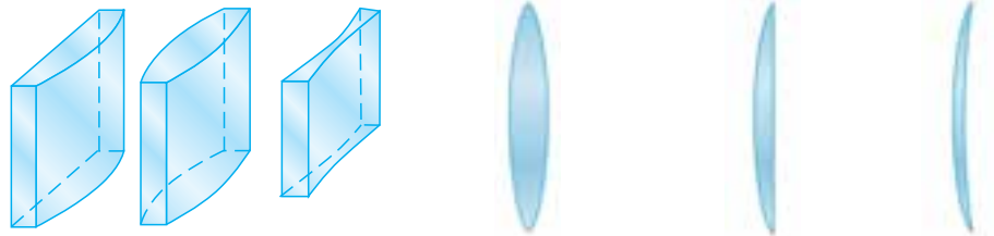
الف) دو کوژ کروی (ب) کوژ تخت کروی (پ) هلالی همگرای کروی (ت) عدسی های همگرای استوانه ای
