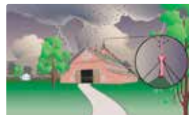
شکل ۳-۷- برق‌گیر، ساختمان را از خطر برخورد آذرخش (صاعقه) حفظ می‌کند.
