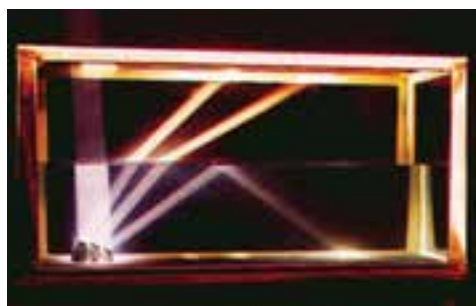
شکل ۵-۹ - گذار نور از محیط شفاف با ضریب شکست بیشتر به محیط شفاف با ضریب شکست کمتر و بازتاب کلی.
